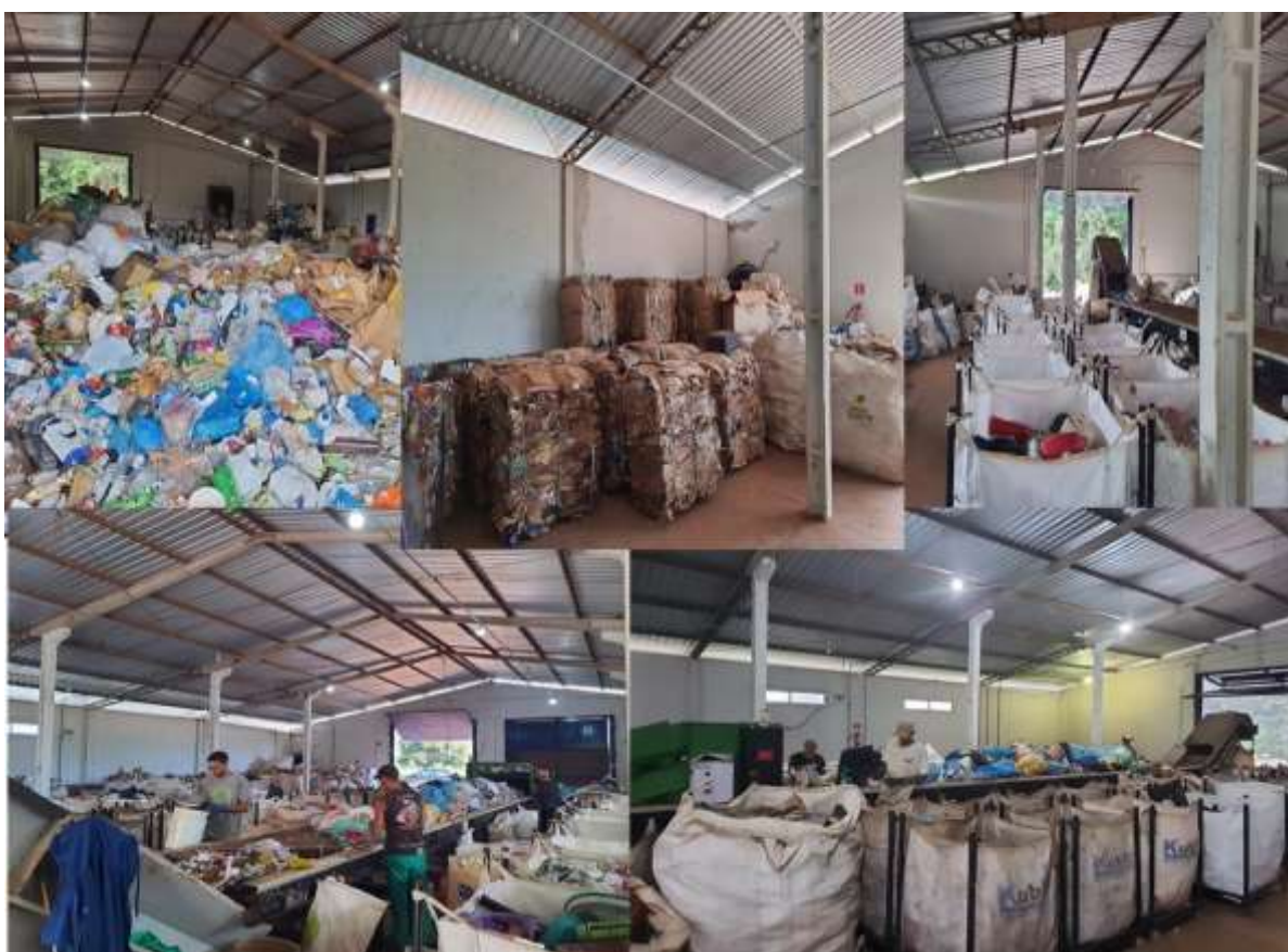
Figura 40. Associados realizando triagem de material reciclável na UVR
