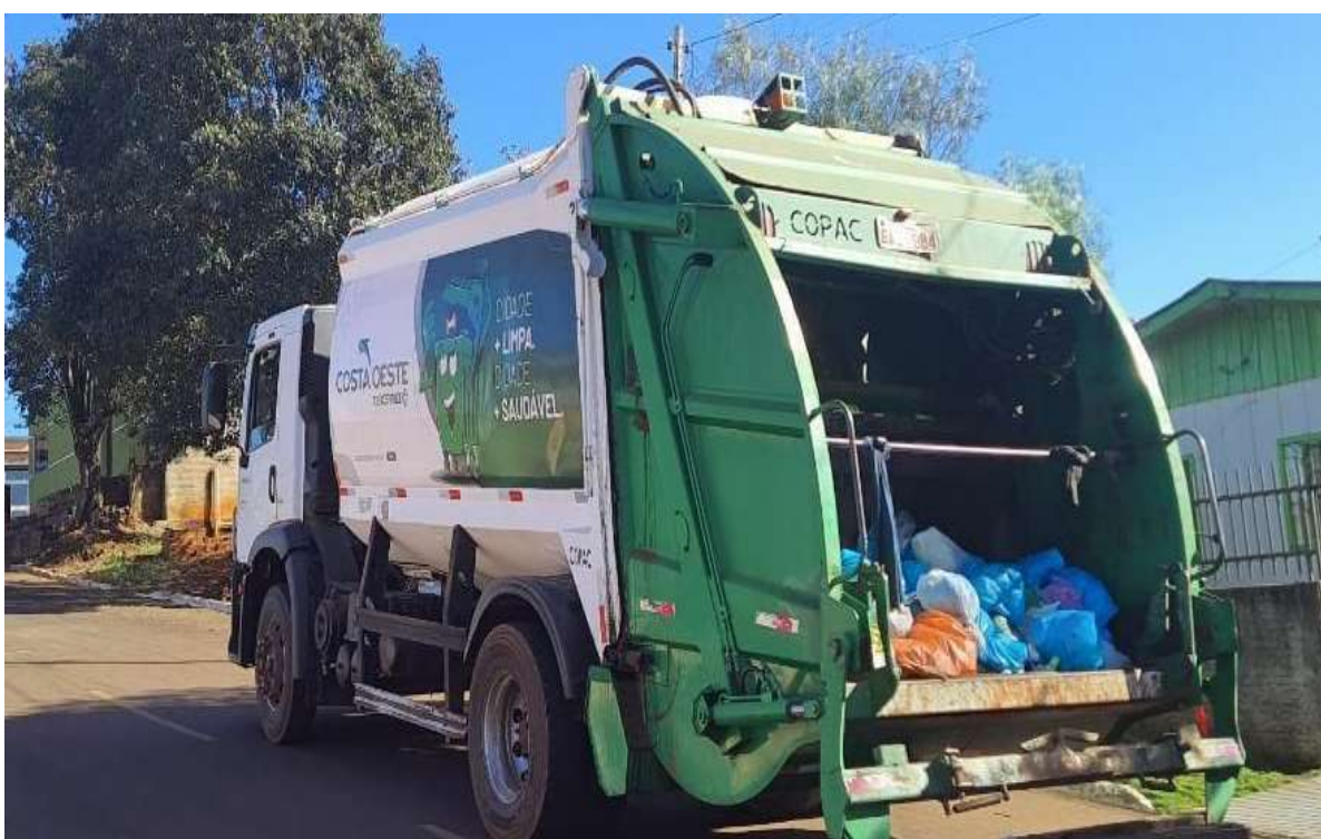
Figura 24. Caminhão compactador utilizado na coleta dos resíduos não recicláveis
