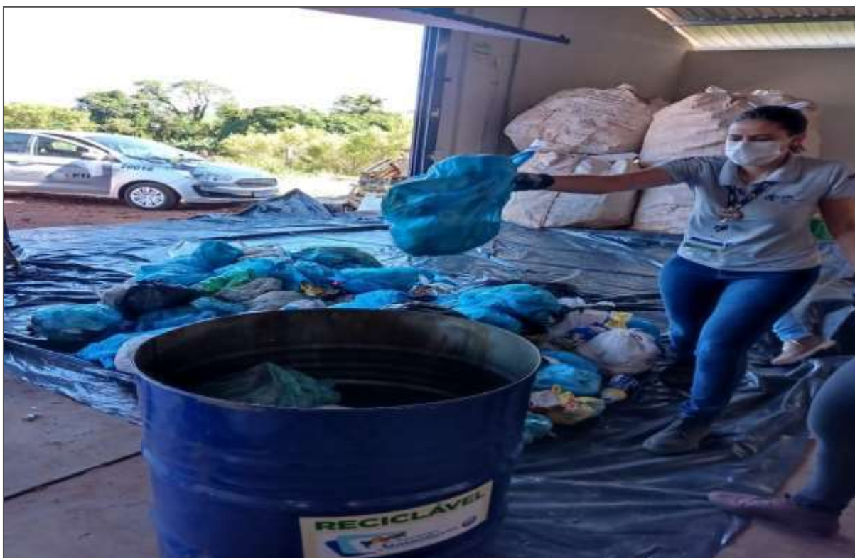
Figura 46. Realização do preenchimento das 04 bombonas com as sacolas de resíduos para o estudo da composição gravimétrica dos resíduos do município de Catanduvas/PR
