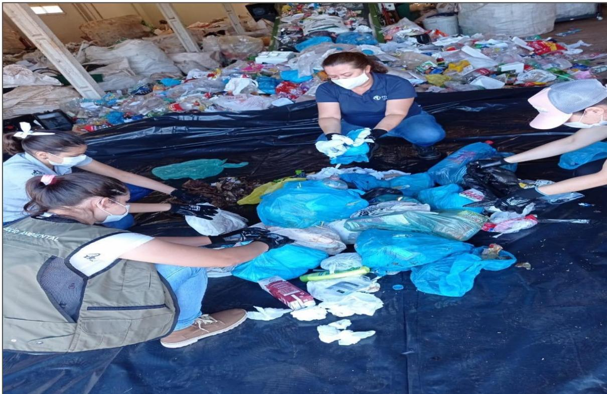
Figura 50. Separação para posterior pesagem em balança digital e classificação dos resíduos segundo sua tipologia para o estudo da composição gravimétrica dos resíduos do município de Catanduvas/PR
