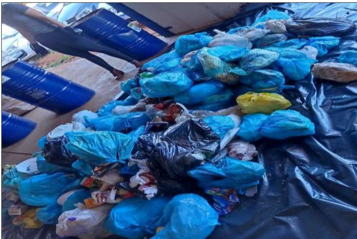
Figura 45. Pilha de resíduos descarregados pelo caminhão de coleta e separação de sacos contendo resíduos para realização do estudo da composição gravimétrica dos resíduos do município de Catanduvas/PR
