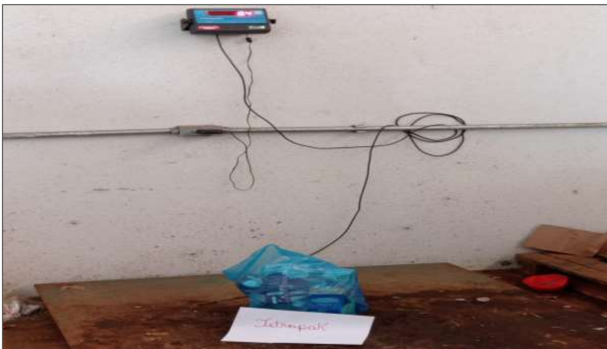
Figura 51. Pesagem de resíduos em balança digital, segundo sua tipologia, para o estudo da composição gravimétrica dos resíduos do município de Catanduvas/PR
