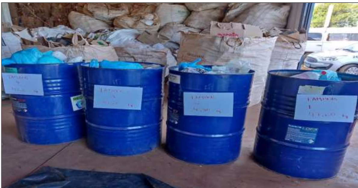
Figura 47. Após o completo preenchimento das bombonas as mesmas foram pesadas e selecionadas para sequência do estudo da composição gravimétrica dos resíduos do município de Catanduvas/PR
