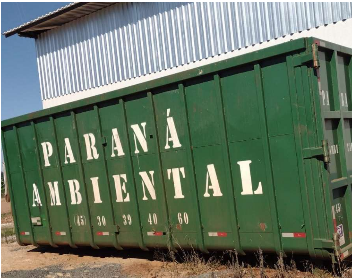
Figura 21. Container para armazenamento temporários dos resíduos volumosos e inservíveis
